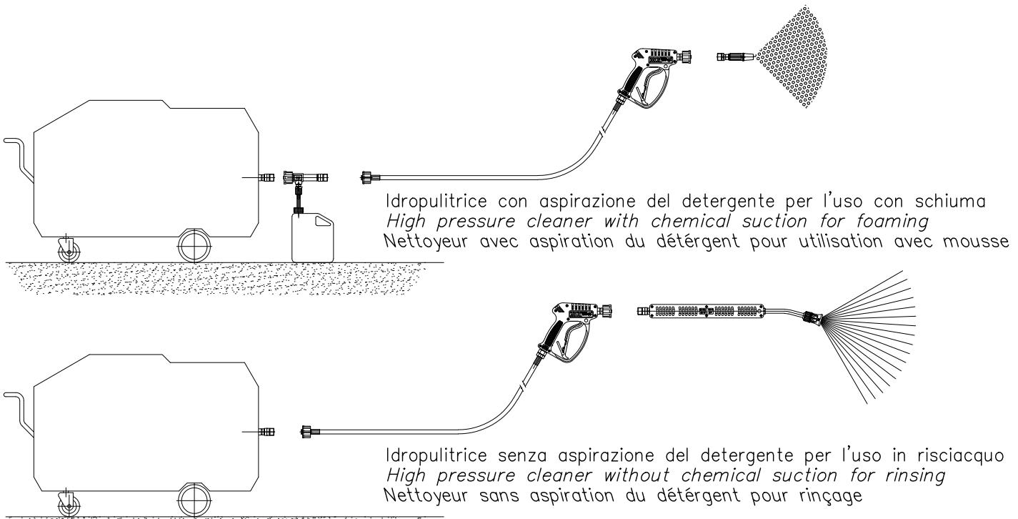
USO SU IMPIANTI FISSI DELLA LANCIA SCHIUMA LS 3 CON ASPIRAZIONE ESTERNA + INIETTORE
